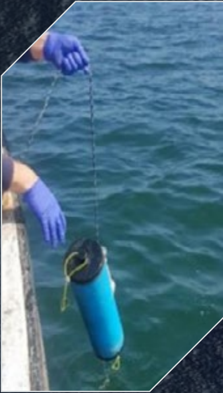
Equipamiento para el muestreo de columna de agua y sedimento marino.
