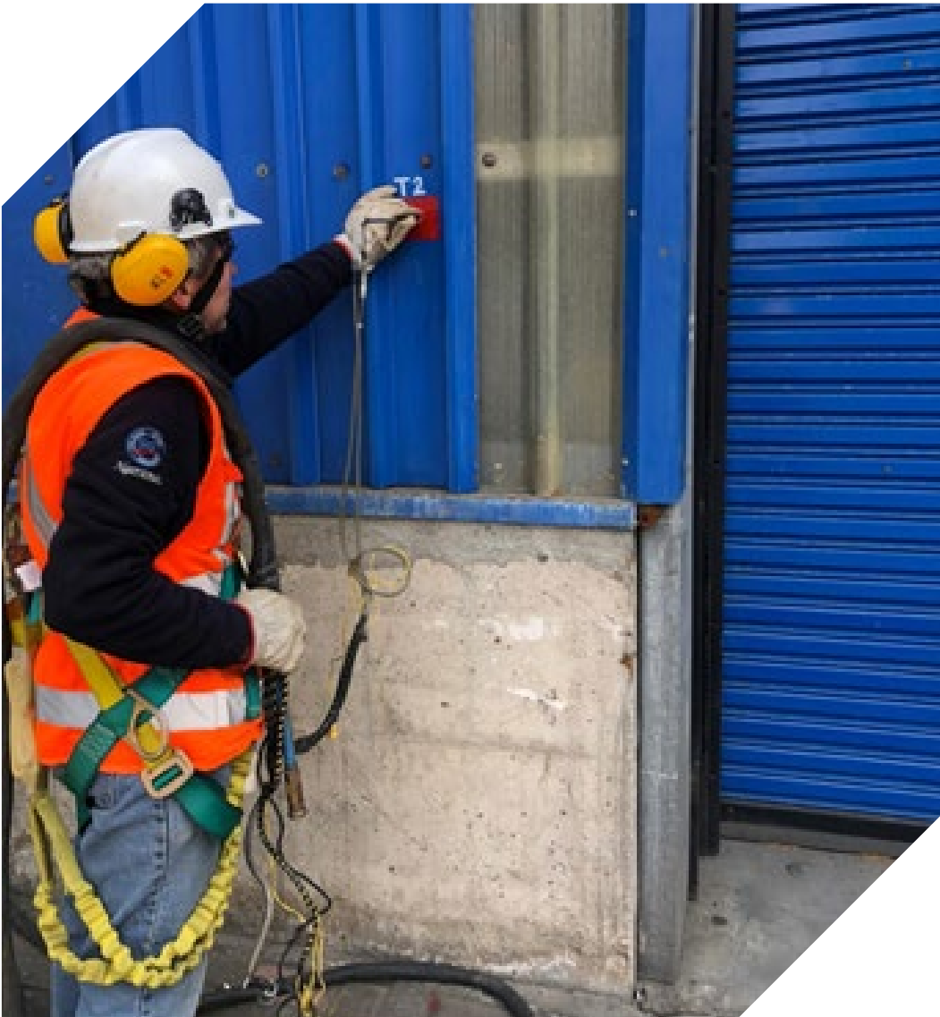
● Proceso de medición de presión en galpones, y muestreo en fuente del sistema de control de material particulado.
