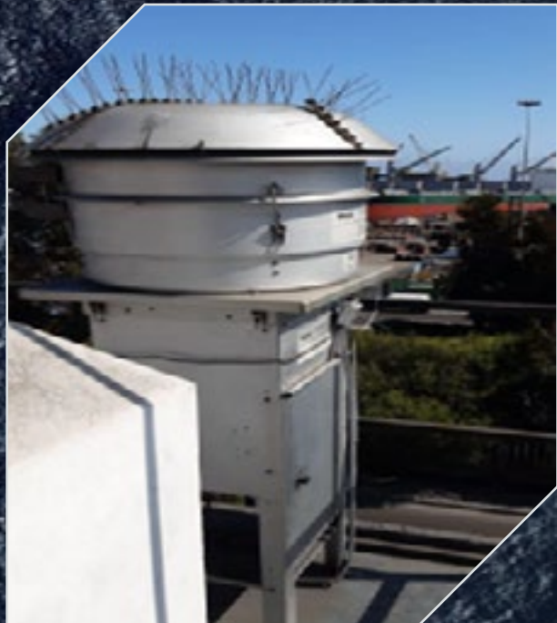
Estación Capitanía de Puerto: un muestreador de material particulado respirable de alto volumen MP-10 (monitoreo discreto).
